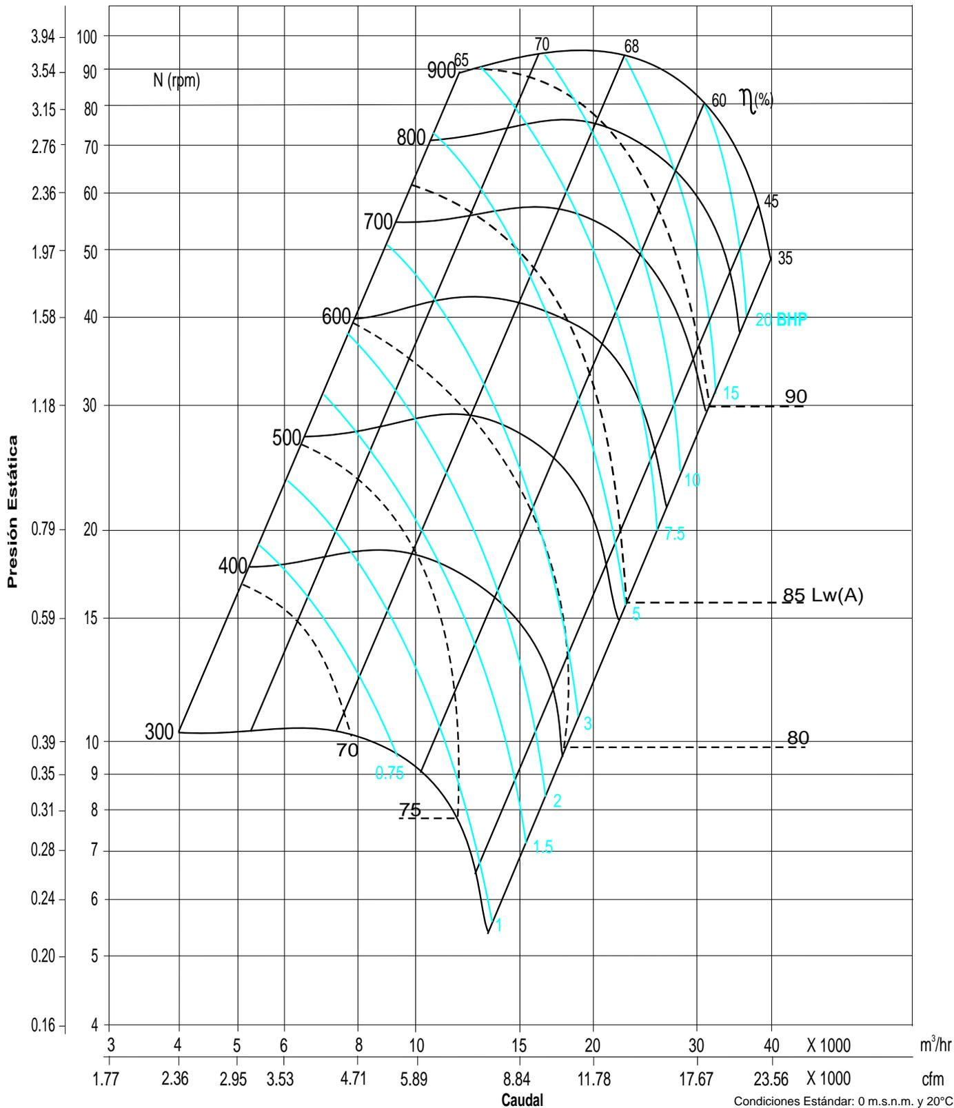
Los valores de caudal y presión están certificados para instalación tipo B: Sin ducto en la succión y ducto en la descarga. Estos valores no incluyen los efectos de accesorios. Los valores de potencia (BHP) no incluyen las pérdidas por transmisión.
