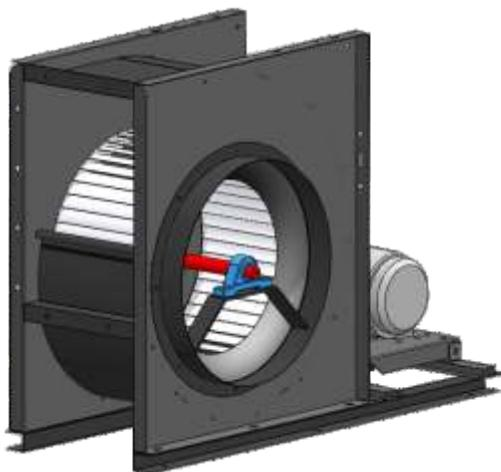
Los ventiladores SA son ventiladores centrífugos de simple oído, equipados con rodets de álabes curvos adelantados. El diseño de este tipo de rodets es especial para manejar grandes caudales de aire a medianas presiones estáticas; manteniendo un bajo consumo de energía. Estas prestaciones altas, se deben llevar a cabo en condiciones de aire limpio, sin polvo o grasa, con temperaturas no mayores a 80 °C.
